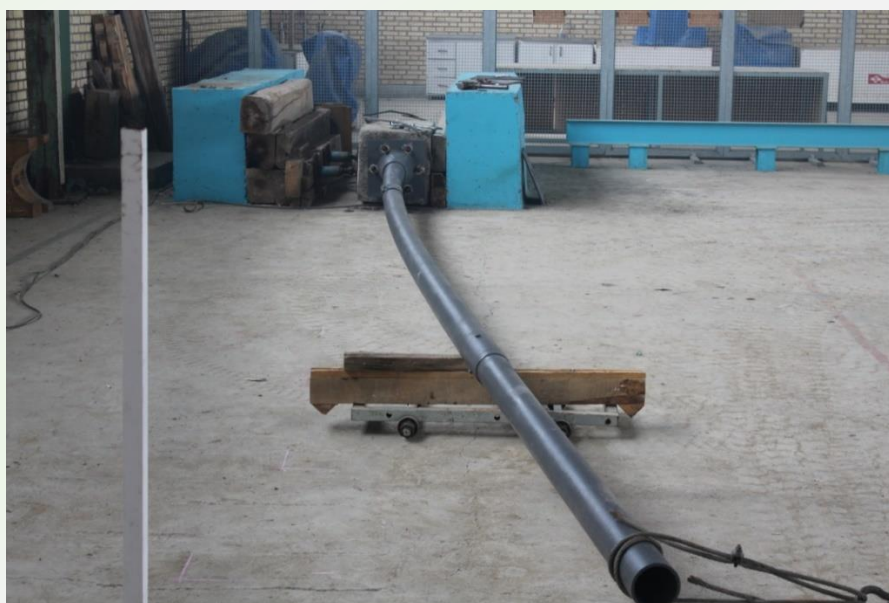
شکل ۸. نحوه اعمال نیرو به پایه روشنایی ۹ متری
