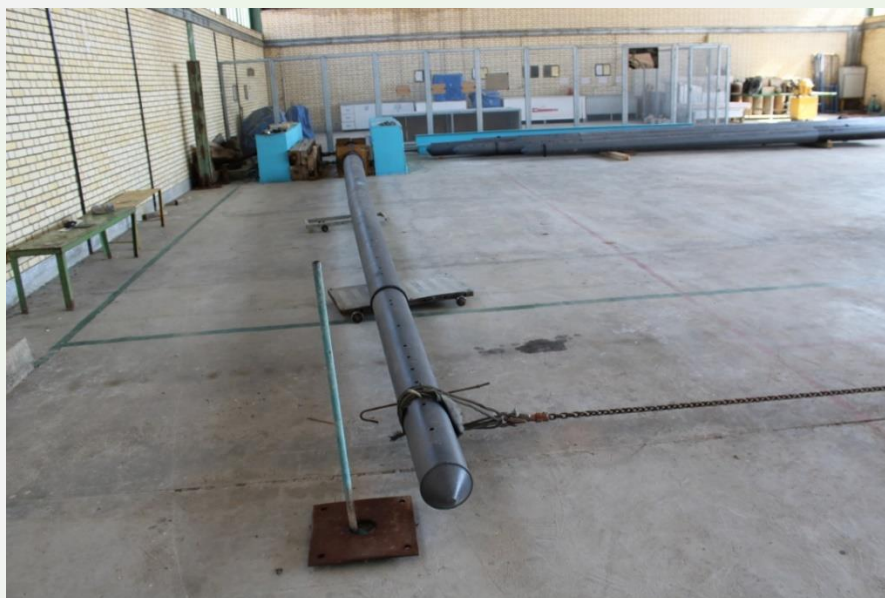
شکل ۷. نحوه اعمال نیرو به پایه روشنایی چدنی
