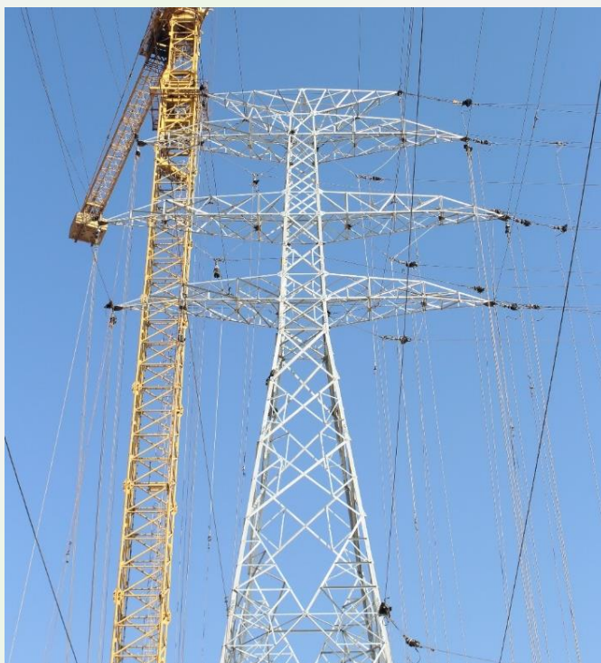
شکل ۳. نمونه‌ای از نحوه اتصال کابل‌های اعمال نیرو بر روی دکل KZS4-3
